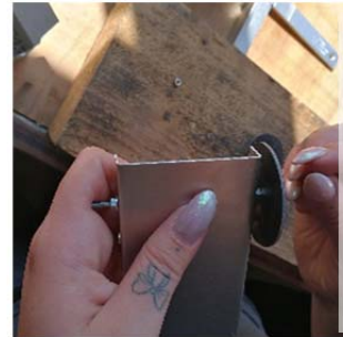
A tengelyeket dugjuk át a lyukakon és helyezük fel a kerekeket.
