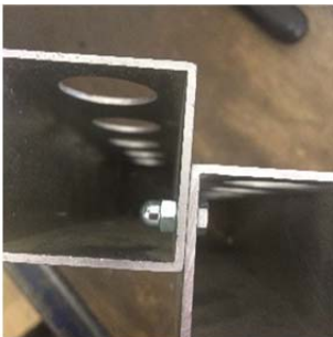
Csavarozzuk össze a három alkatrészt (M4-es csavarral),
