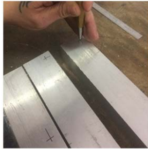
... majd pontozzuk meg! (A harmadik alkatrészen a láb helyét is jelöljük!)
