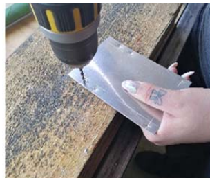
... készítsünk furatokat a tengelyekhez (a felső széltől 20 mm távolságra).
