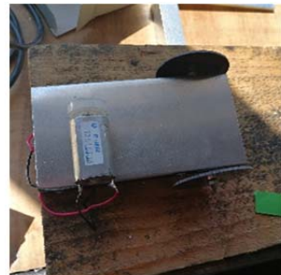
Dugjuk rá a kis kereket a motorra, majd ragasszuk oda a motort.
