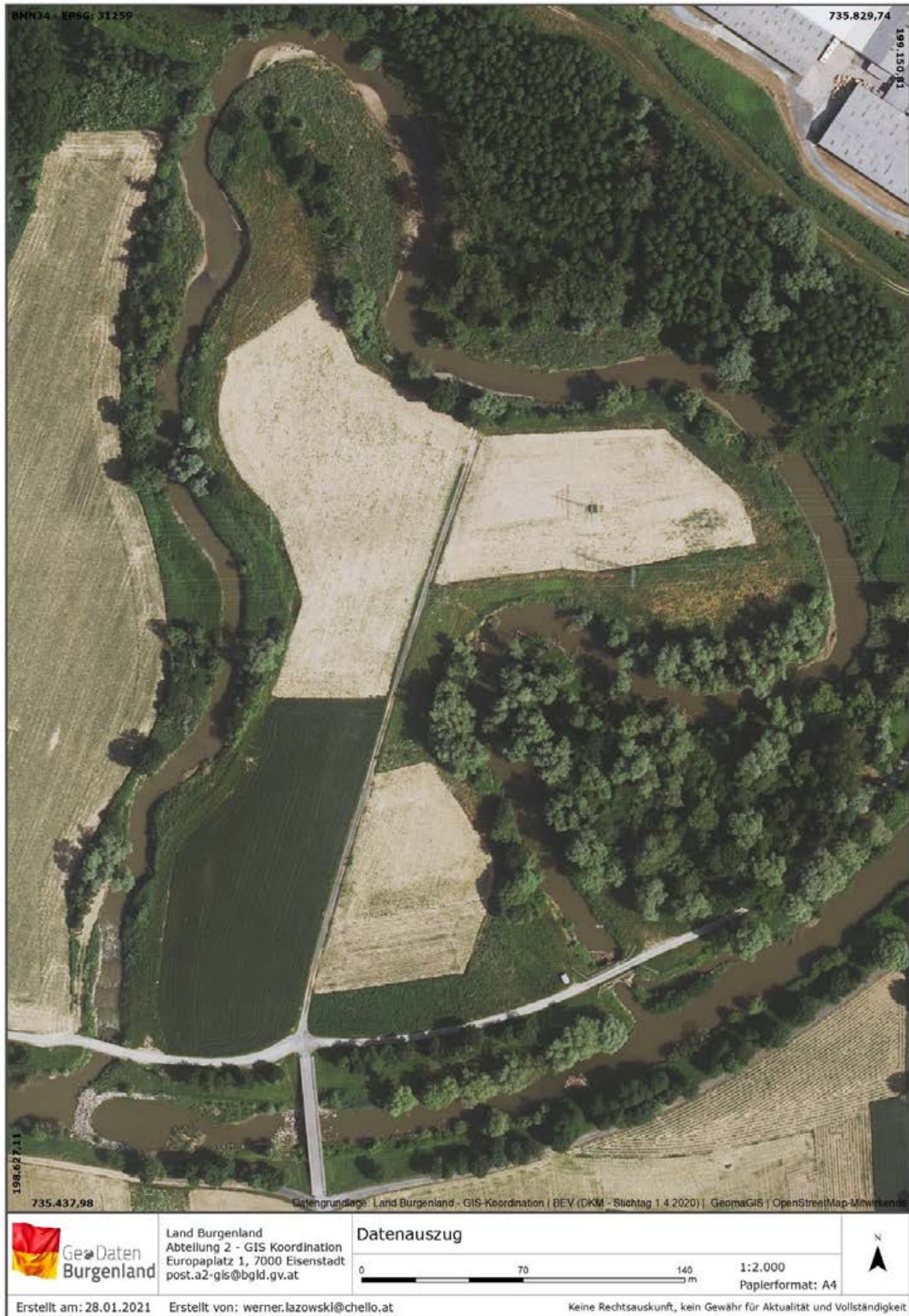
Abbildung 92: Rückgebauter Vossen-Arm bei Jennersdorf. Mittelwasser-Ausleitung aus dem regulierten Raab-Durchstich (im Bild unten) © Land Burgenland
