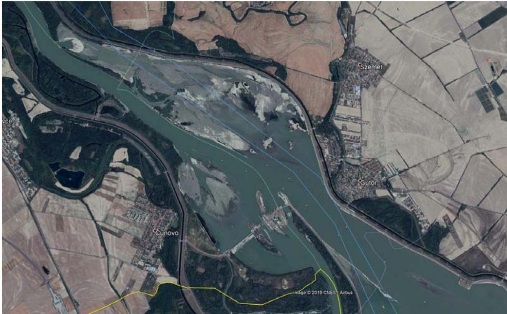
Abbildung 41 Sedimentablagerungszonen stromauf des KW Gabčíkovo (Google Earth)
