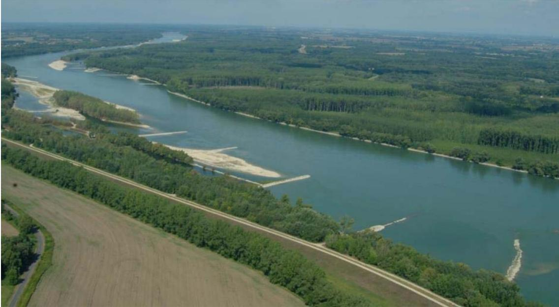
Abbildung 26 Flussbauwerke bei Niedrigwasserniveau um Strom-km 1799 (Luftaufnahme von 2011)
