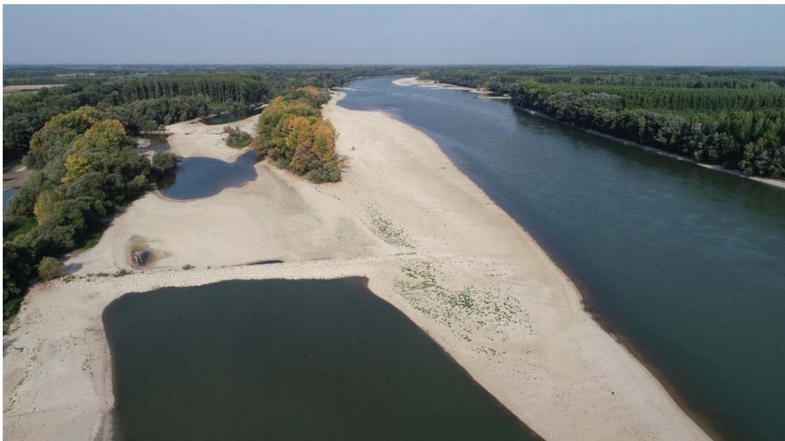
Abbildung 33 Verlandeter Seitenarm in der Nähe von Vének, Strom-km 1798 (Quelle: ÉDUVIZIG, 2018)
