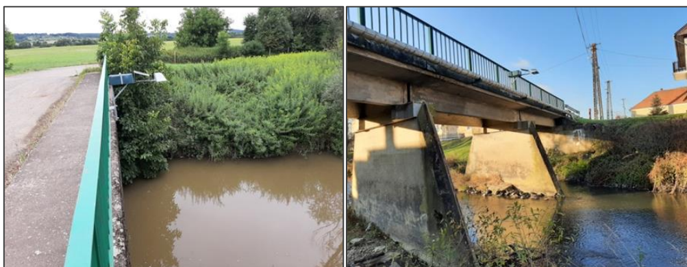
12. ábra: Telepített radaros vízszintmérő állomások a magyar oldalon (bal: Szentpéterfa; jobb: Vaskeresztes)
